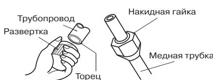
3. Отсоедините накидные гайки, прикрепленные к внутреннему и наружному блокам кондиционера. Затем установите их на трубы, с которых уже удалены заусенцы и надета теплоизоляция.
