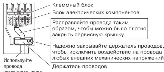
8. Присоединяйте провода заземления к соответствующим контактным выводам.
