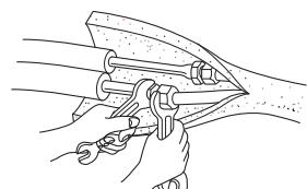
4. Отметьте необходимую длину каждой трубы и дренажного шланга для соединения с выходными трубами внутреннего блока. Присоедините трубопровод между блоками.
