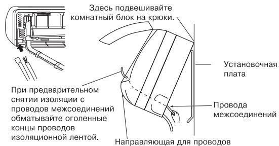
6) Надавите на нижнюю часть корпуса внутреннего блока обеими руками для закрепления его на крюках монтажной пластины. Следите за тем, чтобы по краям комнатного блока не было защемленных проводов.
