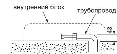
небольшим запасом, далее подвесьте комнатный блок на крюки монтажной пластины.
