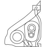
5. Утеплите соединительные гайки теплоизоляцией и обмотайте трубы для хладагента изоляционной лентой. Уложите трубопроводы как показано на рисунке для случая подвода дренажного шланга через заднюю часть комнатного блока.
