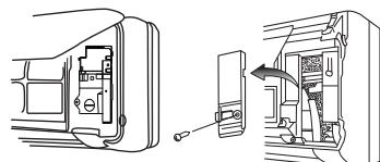
6. Откройте лицевую панель, далее снимите сервисную крышку и пропустите провода межблочных соединений от наружного блока через отверстие в задней части корпуса внутреннего блока. Выведите их с лицевой стороны.
