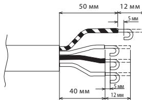
7. Следите за соответствием цвета изоляции проводов номерам контактных выводов клеммных колодок внутреннего и наружного блоков и надежно привинчивайте провода к соответствующим клеммам.
