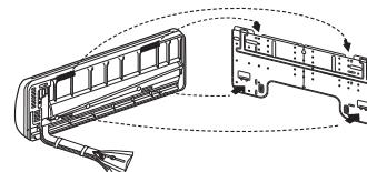
5) Пропустите провода межблочных соединений от наружного блока через отверстие в задней части корпуса внутреннего блока. Выведите их с лицевой стороны.
